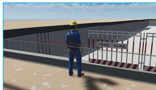
基坑临边水平生命线效果图
