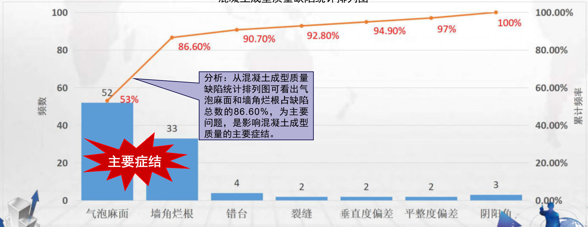
混凝土成型质量缺陷统计排列图
