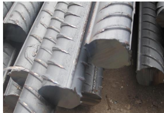
图 2.2-4 钢筋切平头实例图
