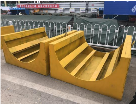
图 1.2-4 圆盘钢筋摆放支撑平台
