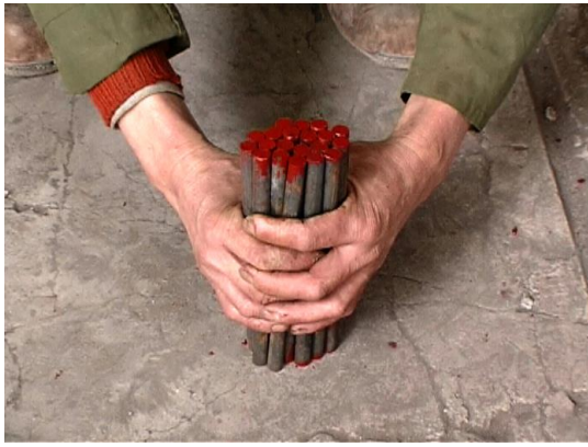
图 3.2-8 钢筋顶模棍加工照片
